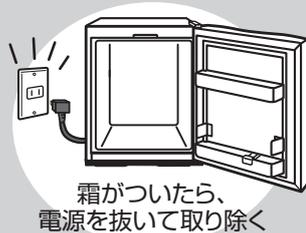
(温度調節ダイヤルにより、庫内温度を高めめに調節することにより霜がつきにくくなります。)
