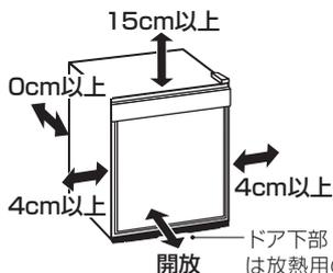
ドア下部(露受け皿前部)は放熱用の空気が流れる通気孔です。ふさがないように設置してください。
