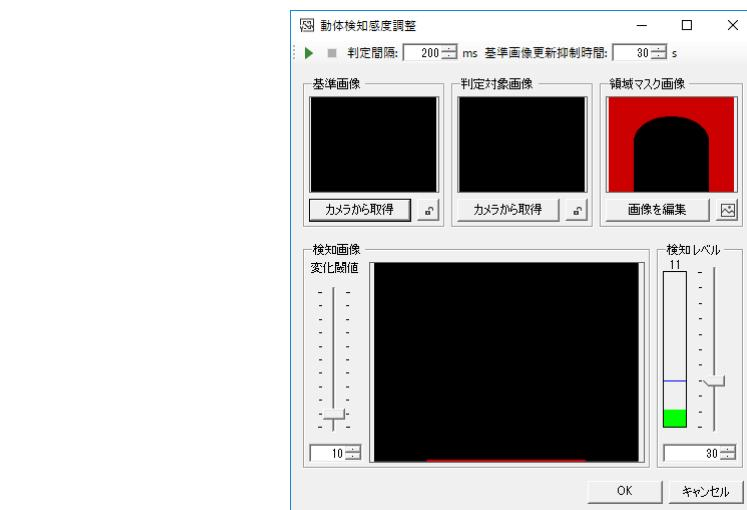
動体検知状態のテストを行います。設定された内容に従い連続して検知レベルを更新します。
