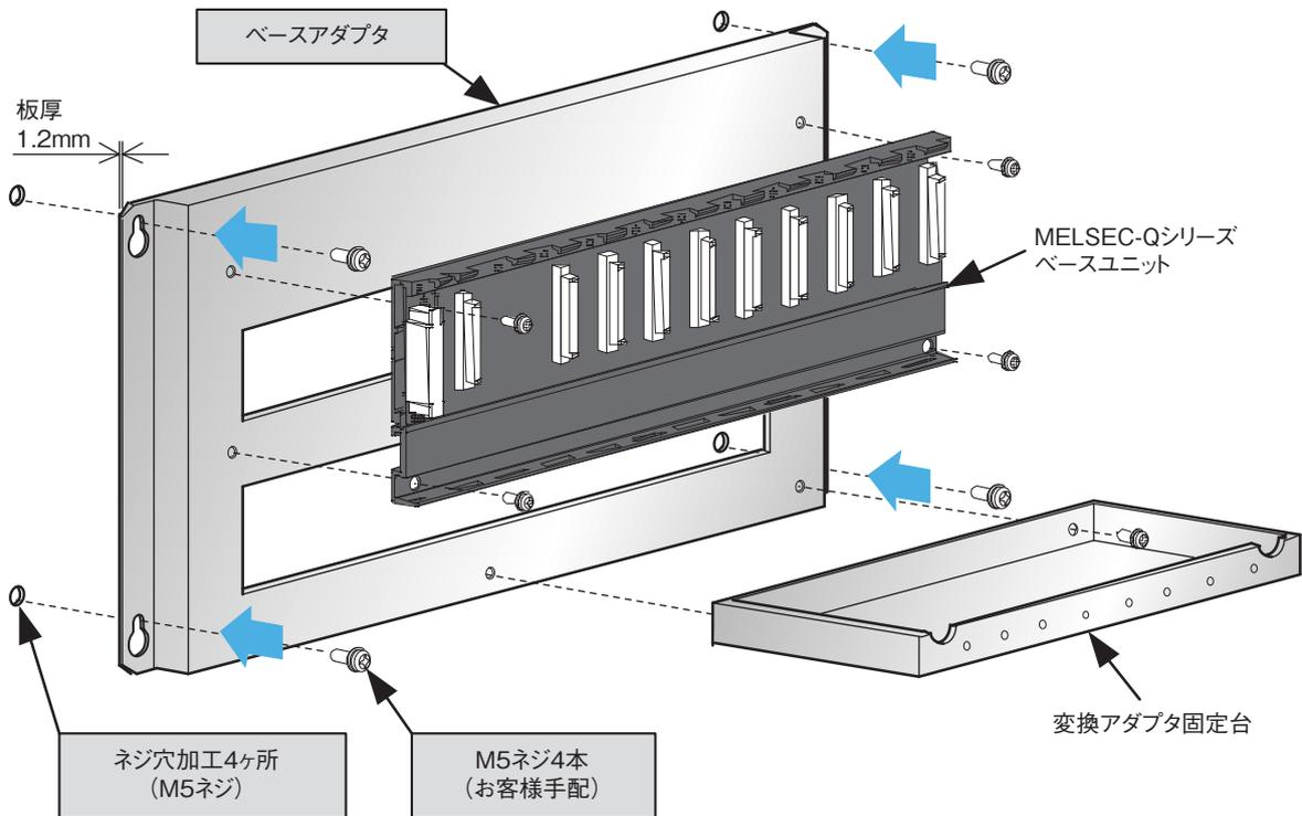
同じベースユニット (\*1~\*5) が複数のベースアダプタにおいて取付けできますので、製品寸法により最適なベースアダプタをご使用ください。
