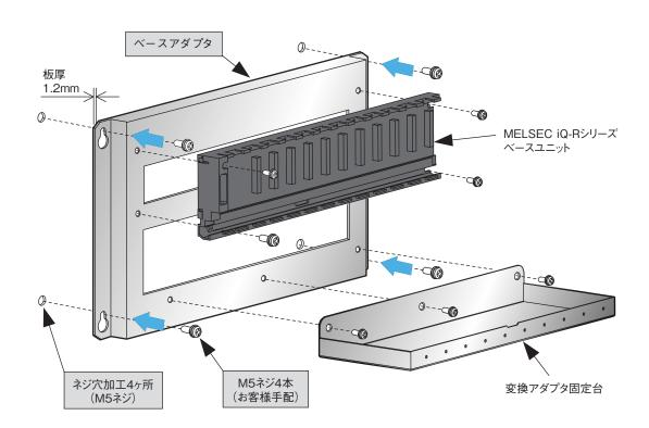
同じベースユニット(※1~※3)が複数のベースアダプタにおいて取付けできますので、製品寸法により最適なベースアダプタをご使用ください。
