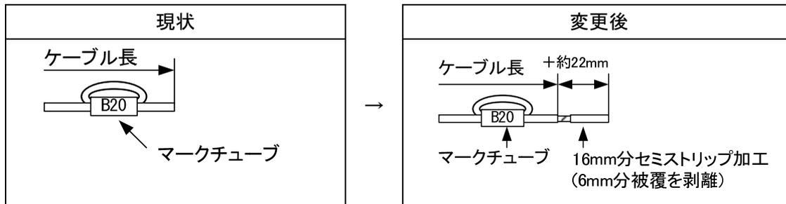
※セミストリップ加工とは、被覆を完全に剥離しない状態で加工したものです。
