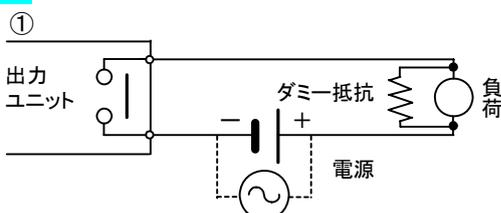
・リレーON時の負荷電流を多くして接触不良を防止します。
