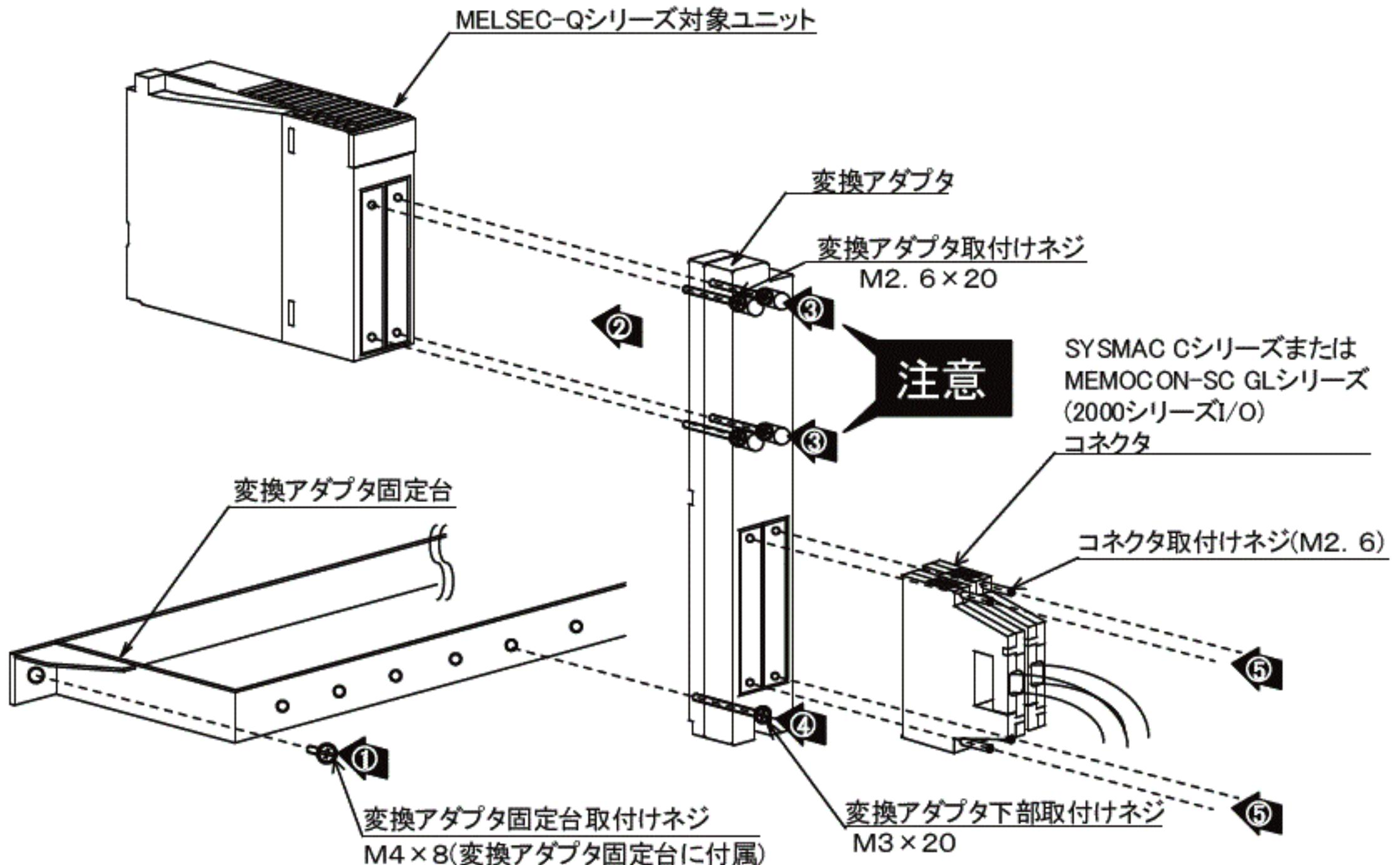
① 変換アダプタ固定台をベースアダプタもしくは制御盤に、付属の変換アダプタ固定台取付けネジ(M4×8)で固定してください。(両端2ヶ所)
