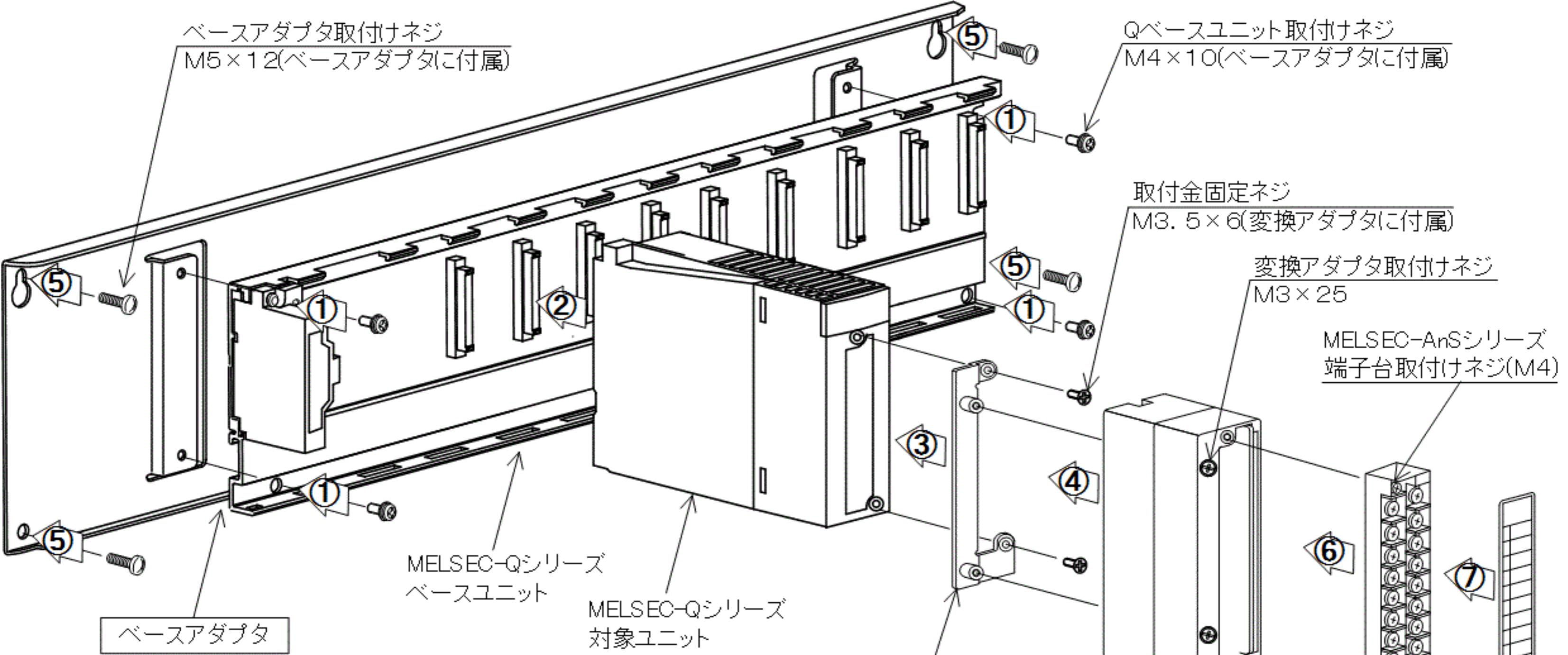
既設システムが DIN レール取付けの場合、ベースアダプタは不要です。ご使用になる MELSEC-Q シリーズベースユニットを DIN レール取付けにてご使用ください。
