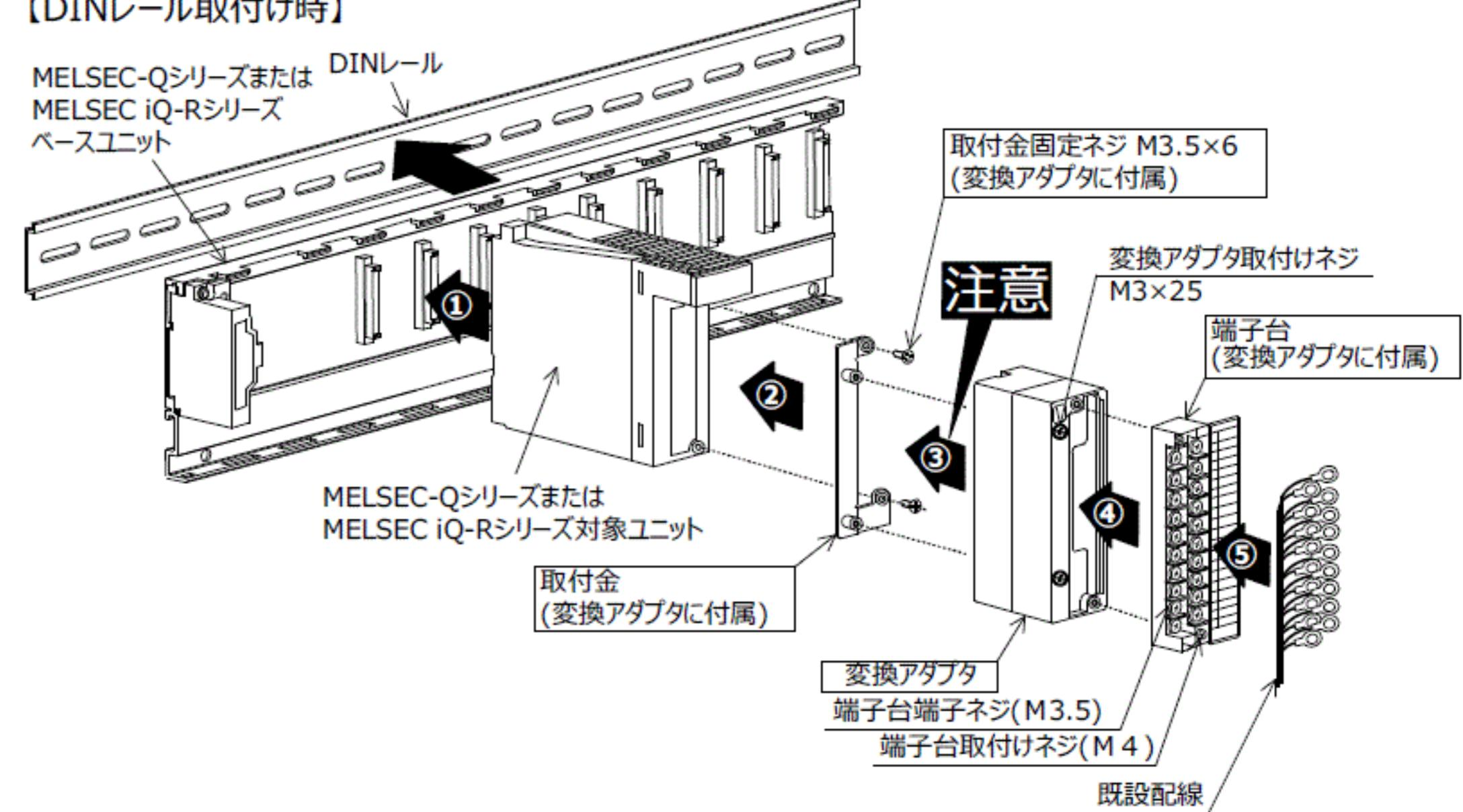
同じベースユニット上に固定台付き変換アダプタおよび温度調節ユニット用断線検知コネクタ変換ケーブルを使用される場合、別売のベースアダプタ（ERNT-ASQB□□N）が必要になります。取付け方法は、ベースアダプタのマニュアルを参照ください。
