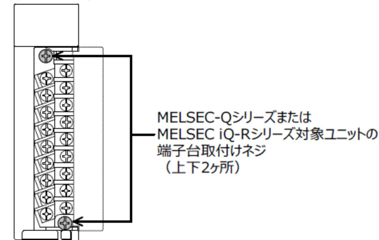
② 取付金を対象シーケンサユニットに取付金固定ねじ(M3.5×6)で固定してください。(2ヶ所)
