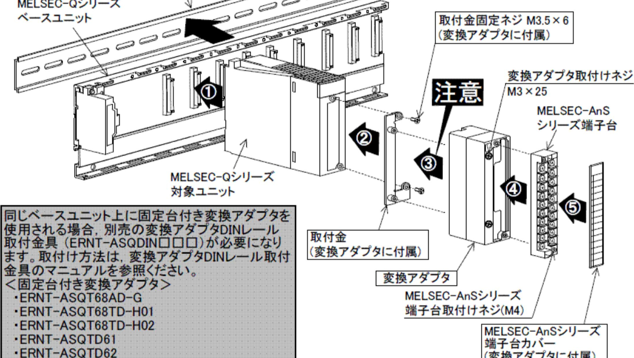
同じベースユニット上に固定台付き変換アダプタを使用される場合、別売の変換アダプタDINレール取付金具(ERNT-ASQDIN□□□)が必要になります。取付け方法は、変換アダプタDINレール取付金具のマニュアルを参照ください。
