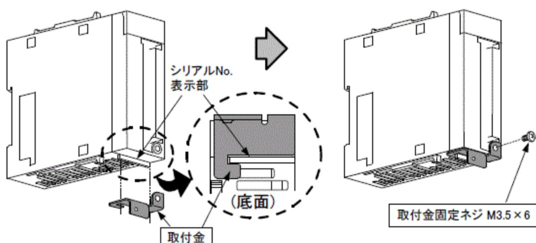
③ MELSEC-Lシリーズ対象ユニットに変換アダプタを装着し、変換アダプタ取付けネジ(M3 x 25)で固定してください。(1ヶ所)
