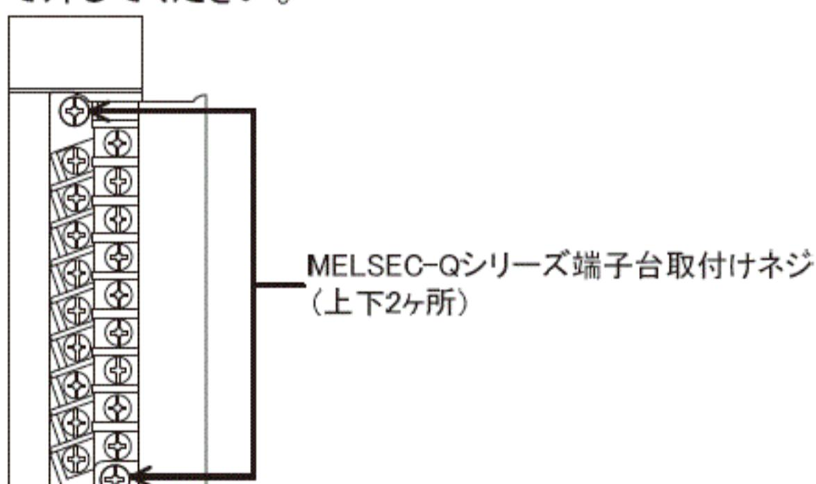
取付金をMELSEC-Qシリーズ対象ユニットに取付金固定ネジ(M3.5×6(変換アダプタに付属))で固定してください。(上下2ヶ所)
