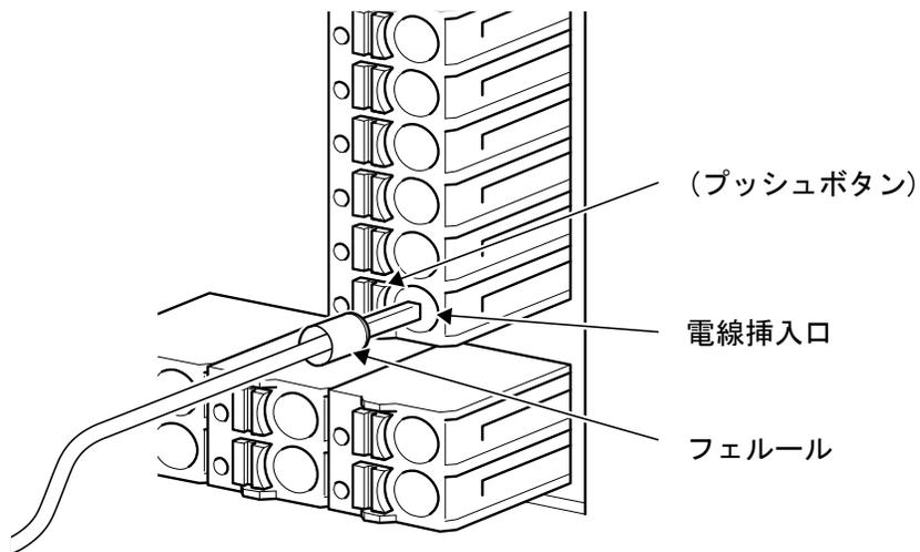
撚り線を結束する場合、ドライバを使用してプッシュボタンを押した状態で、電線挿入口に撚り線を挿し込んでください。
