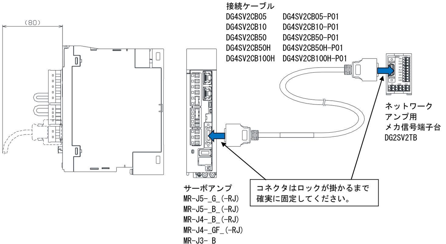
6-2. DG2SV2TB2 のサーボアンプへの接続時
