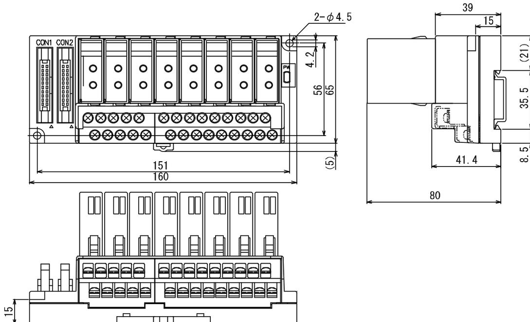
5-3. 入力タイプ 4チャンネルベースユニット スプリングクランプ端子台タイプ(FA1-AT1B4X1TE)
