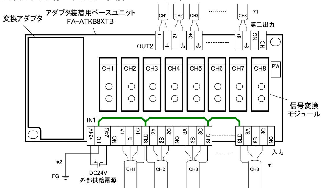
\*1：電線にはシールド線を使用し、シールドは接地を行ってください。尚、FA-ATKB8XTBの入力端子台(IN1)のSLD端子は、内部でFGと接続されており、外線のシールドを接地する中継端子として使用できます。
