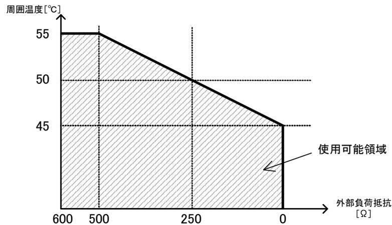
②平取付け時に信号変換モジュール「FA-ATSVM1XD」を 3 台以上使用する場合は周囲温度を 50℃以下でご使用ください。
