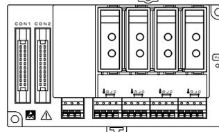
\*1：ケーブルのFG線は、制御盤に接地してください。
