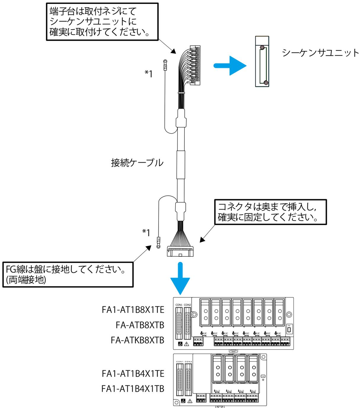
\*1：ケーブルのFG線は、制御盤に接地してください。
