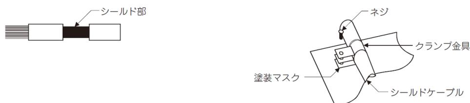
注)下記のようにシールドケーブルのシールド部にビニール電線をハンダ付けして、その先で接地処理をする方法は高周波インピーダンスが高くなりシールドの効果なくなるため、注意してください。
