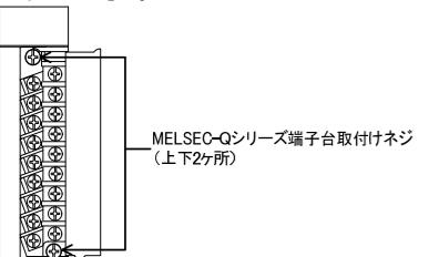
取付金をMELSEC-Qシリーズ対象ユニットに取付金固定ねじ(M3.5×6(変換アダプタに付属))で固定してください。(4ヶ所)
