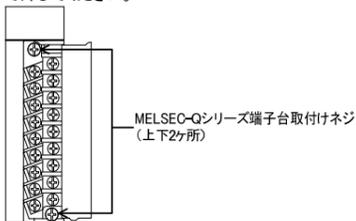
取付金をMELSEC-Qシリーズ対象ユニットに取付金固定ネジ(M3.5×6(変換アダプタに付属))で固定してください。(4ヶ所)
