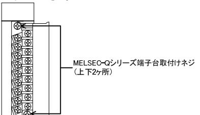
取付金をMELSEC-Qシリーズ対象ユニットに取付金固定ネジ(M3.5×6(変換アダプタに付属))で固定してください。(上下2ヶ所)
