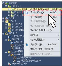
(2)ナビゲーションウインドウのプロジェクトタブにある、【FB・FUN 管理】に、先にコピーした FB をデータ貼り付けします。貼り付けた FB にカーソルを合わせ[F2]を押し、貼り付け後の FB 名称を入力します。(例: Init2)
