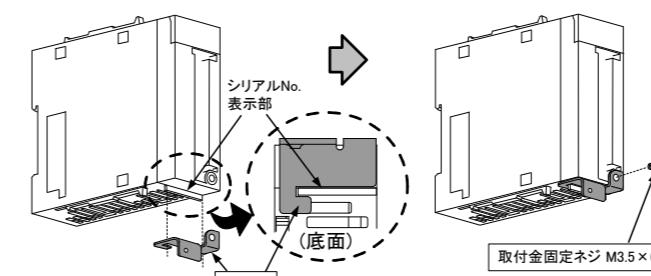
③ MELSEC-Lシリーズ対象ユニットに変換アダプタを装着し、変換アダプタ取付けネジ(M3×25)で固定してください。(1ヶ所)
