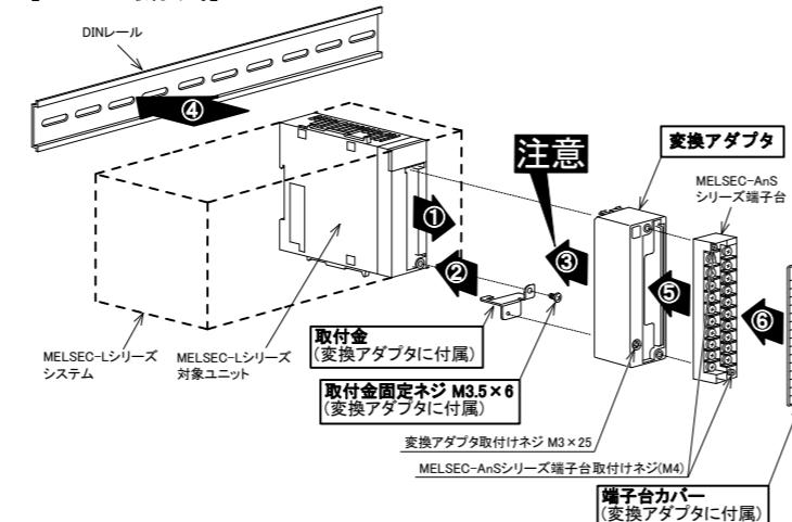
② 取付金をMELSEC-Lシリーズ対象ユニットに取付金固定ネジ(M3.5×6)で固定してください。(1ヶ所)
