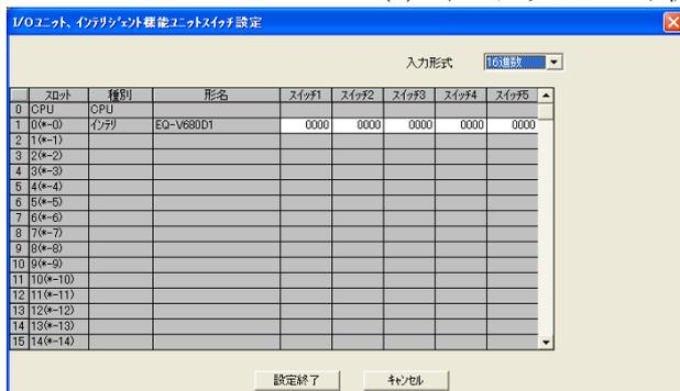
I/O割付設定の画面の[スイッチ設定]をクリックして、下記の画面を表示させ、スイッチ1~5の設定を行います。
