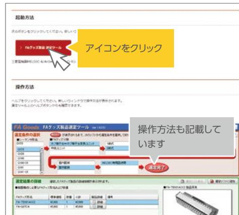
**3** FAグッズ製品選定ツールを起動すると、下記の画面が表示されます。シーケンサ形名の欄にMELSECシリーズのユニット名を入力します。(またはプルダウンメニューから選択) 製品分類の項目を選択するだけで端子台を簡単に選定できます。また、シーケンサと端子台の接続ケーブルも自動的に選定されます。
