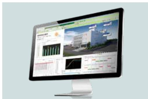
三菱電機株式会社製 SCADAソフトウェア MC Works64をベースとした監視制御システム「e1-Works」によって、工場・ビルの「監える化(監視)」から「診える化(改善)」を実現します。
