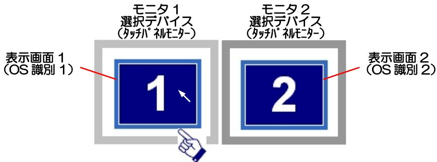
左側の [モニタ 1] 選択デバイスをタッチした場合、左側のモニタ 1 に表示された表示画面 1 の操作を行います。（通常の操作）
