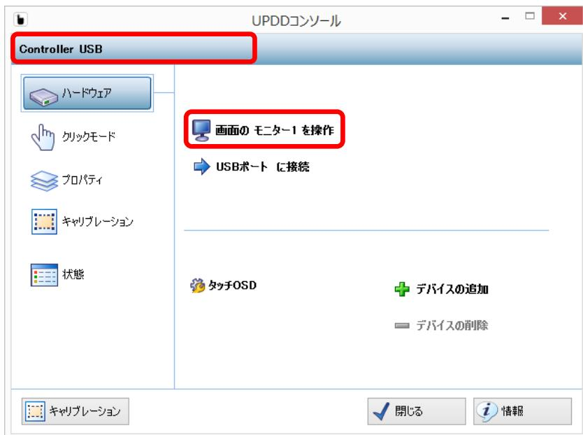
(2) 操作エリアの選択をクリックすると操作エリア設定のウィンドウが表示されるので、指定したデバイスが接続されているタッチモニタのモニタ番号を設定してください。
