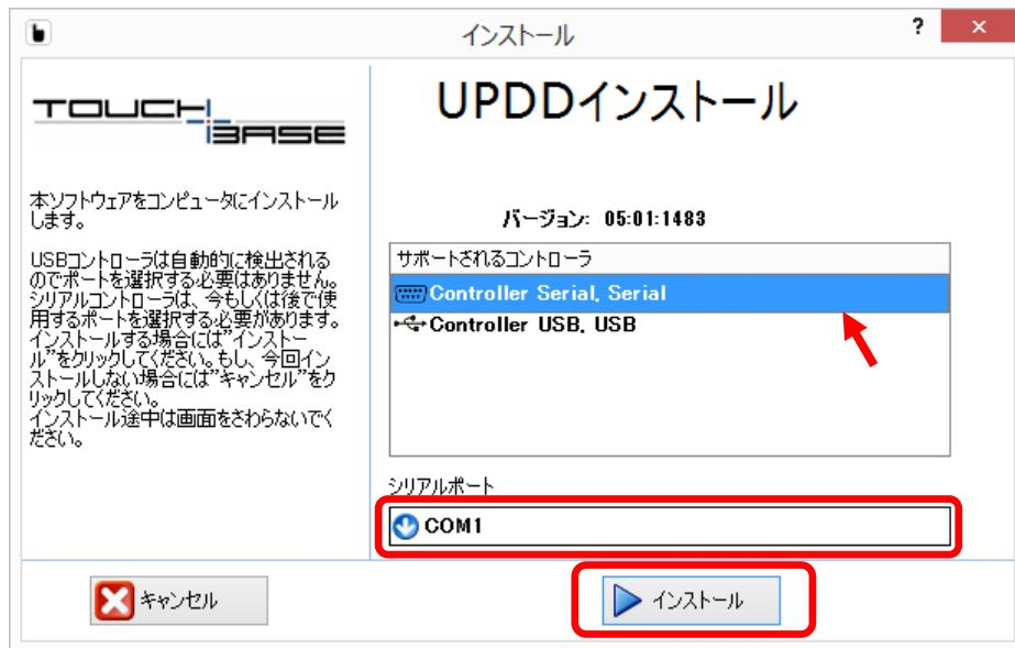
※接続されているシリアルポートが他のソフトウェアで使用されている場合、インストールが完了してもタッチが機能しません。インストールの前に接続先のシリアルポートを確認してください。
