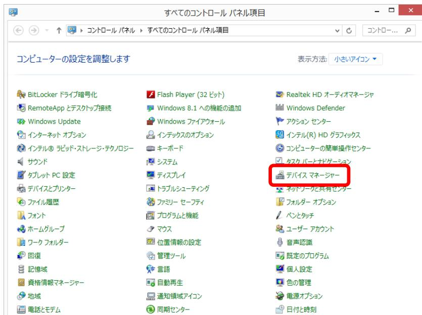
※コントロールパネルで「デバイスマネージャー」が表示されていない場合は、コントロールパネルの[表示方法]を「大きいアイコン」または「小さいアイコン」で表示してください。
