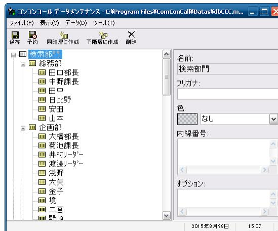
⑫ 「直通電話」の下の階層の「総合案内」を選択して、内線番号を登録します。(メニュー画面に「総合案内」ボタンを表示しない場合は、「直通電話」の下階層の「総合案内」を削除します。)
