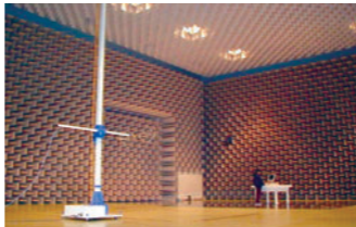
10m法対応電波暗室
